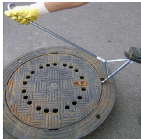
Accessoires pour appareils de levage de couvercles de puits
