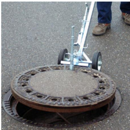
Soulèvements mécaniques de couvercles de puits
