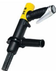
Die Von Arx Nadelpistolen 34 B entfernen rasch Rost, reinigen, entschlacken, und rauhen auf. Im Wesentlichen glätten sie unebene Oberflächen. Da sich die Nadeln frei bewegen, passen sie sich jeder Oberfläche, auch Vorsprüngen, an.
