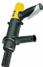
Die Von Arx Nadelpistolen 45 B entfernen rasch Rost, reinigen, entschlacken, und rauhen auf. Im Wesentlichen glätten sie unebene Oberflächen. Da sich die Nadeln frei bewegen, passen sie sich jeder Oberfläche, auch Vorsprüngen, an.
