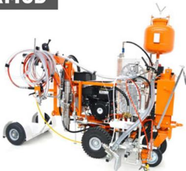
Airlessmaschinen mit hydraulischem Antrieb
