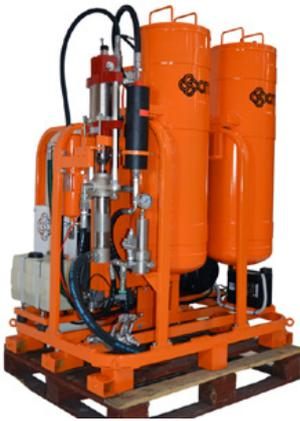
Airlessmaschinen für den Pritschenaufbau
