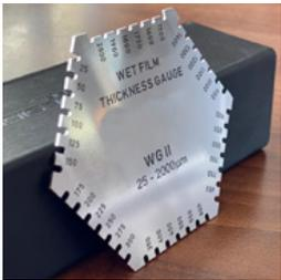
Nassfilm-Messkamm zum Ermitteln der Nassfilm-Schichtstärke. entspricht ISO 2808-7B
