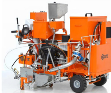
Kylplastmaskiner med hydraulisk drivning
