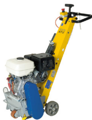
Markeringsfräsmaskiner med 25 cm arbetsbredd
