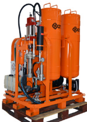
Luftløse maskiner til platformskroppen
