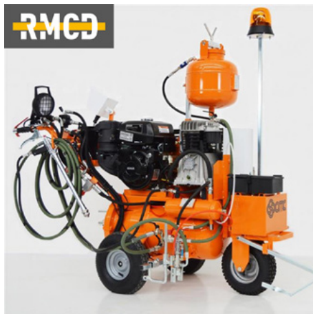
Légpermetező gépek hidraulikus meghajtással
