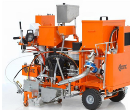
002 Koude kunststofmachines met hydraulische aandrijving
